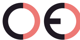
Marca CE falsa (demasiado separados)
